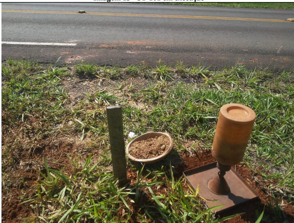
Imagem 16 – Ensaio de massa específica aparente no ST-102
