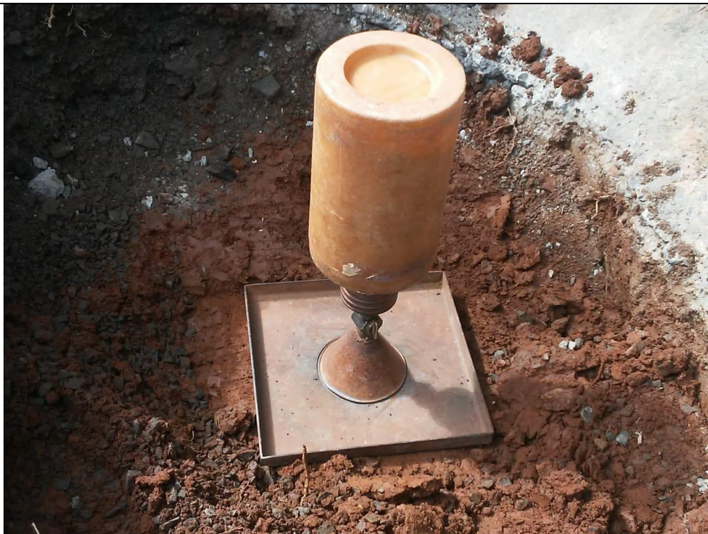
Imagem 17 - Ensaio de massa específica aparente no PI-300
