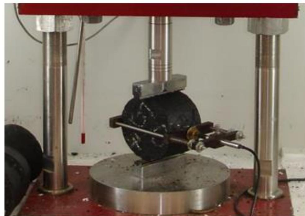
LVDT externo preso ao corpo de prova por alça de referência.
