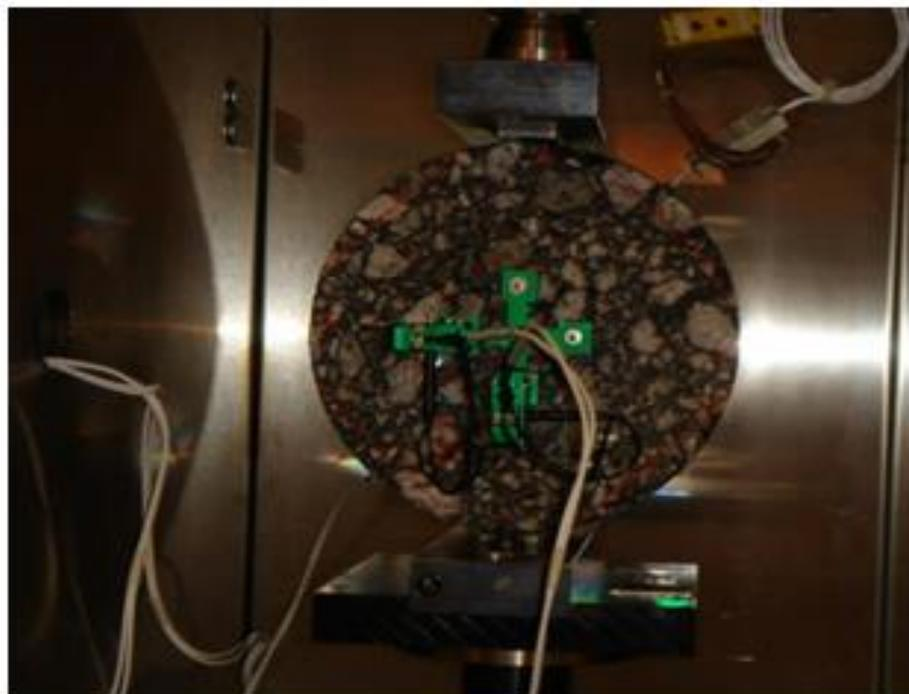
LVDTs colados ao corpo de prova nas duas direções.
