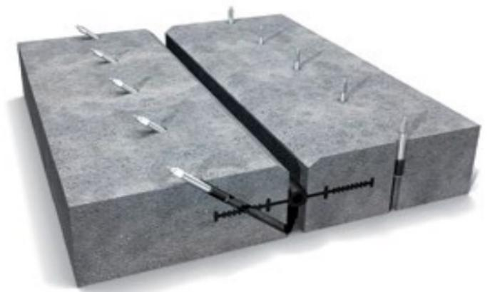
Aplicação de bicos de perfuração em fissuras passantes com juntas fungem-band.
