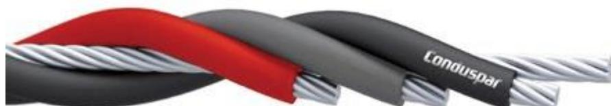
Para alimentação dos postes a partir da rede aérea e para alimentação dos projetores na passagem inferior serão utilizados cabos de cobre multipolar flexível, formado por fios de cobre nu eletrolítico, seção circular, têmpera mole, Classe 5 de encordoamento (NBR NM 280), isolamento das veias à base de PVC, antichama, classe térmica 70°C e cobertura externa PVC, sem chumbo, (NBR 7288). Tensão de isolamento 0,6/1KV, bitola 3x2,5 mm<sup>2</sup>, ref. CONDUSPAR.
