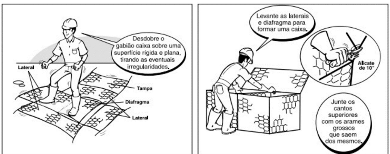
Figura 12 – Pré-montagem do gabião
