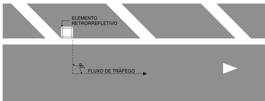
Figura 28 – Posicionamento de tachas e tachões
