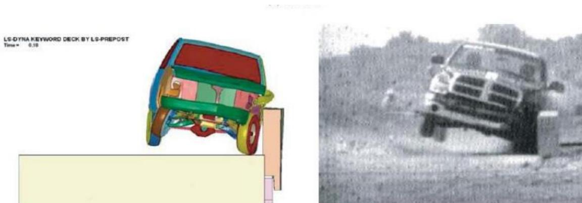
Para a análise matricial foi utilizado um modelo computacional em elementos finitos sólidos, conforme figura abaixo:
