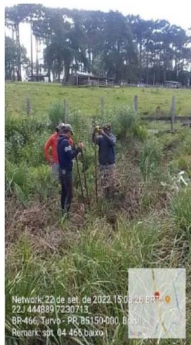
Furo SPT B-04 – ambiente brejoso assente diretamente sobre rocha UTM 444889 / 7230713
