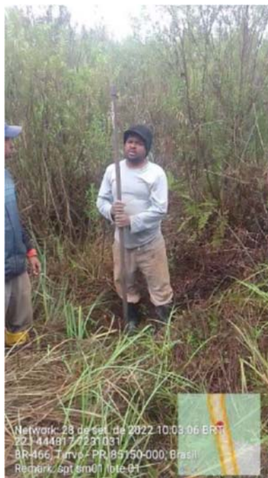
Furo SPT SM-01 – impenetrável à cavadeira durante abertura do furo para instalação do revestimento UTM 444317 / 7231031
