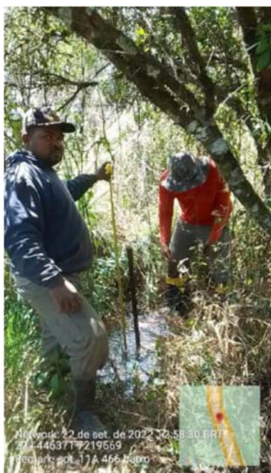
Furo SPT B-11 – ambiente brejoso com ocorrência de camada delgada de material mole (turfa) UTM 446371 / 7219669
