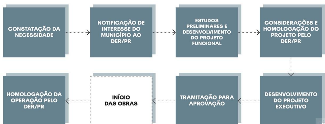
Figura 1 – Fases do processo de construção ou de reforma de um terminal
