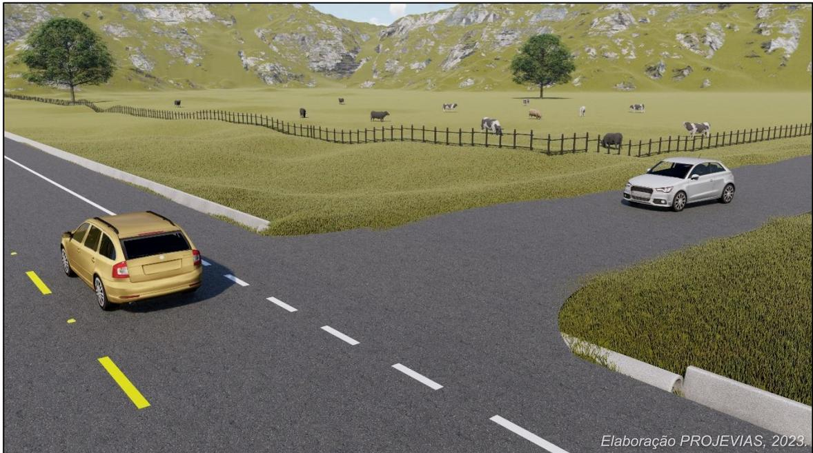
A zona livre se constitui pela área lateral à pista de rolamento que deve ser transpassável, sem obstruções e sem obstáculos fixos e que pode ser utilizada por veículos errantes na necessidade de recuperar o controle do veículo ou chegar a uma parada segura.
