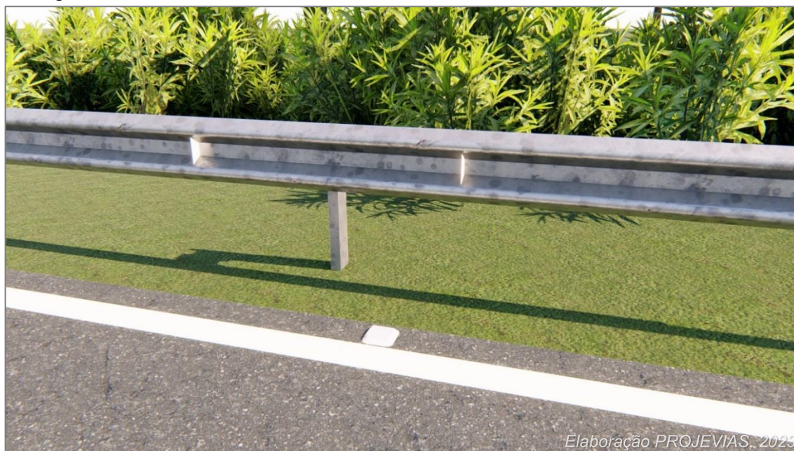
Figura 76 – Posicionamento dos elementos retrorrefletivos na defesa metálica.
