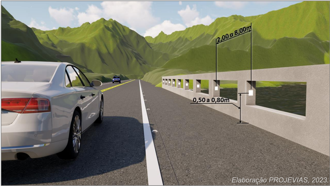
Figura 78 – Posicionamento do elemento Retrorefletivo em pontes.
