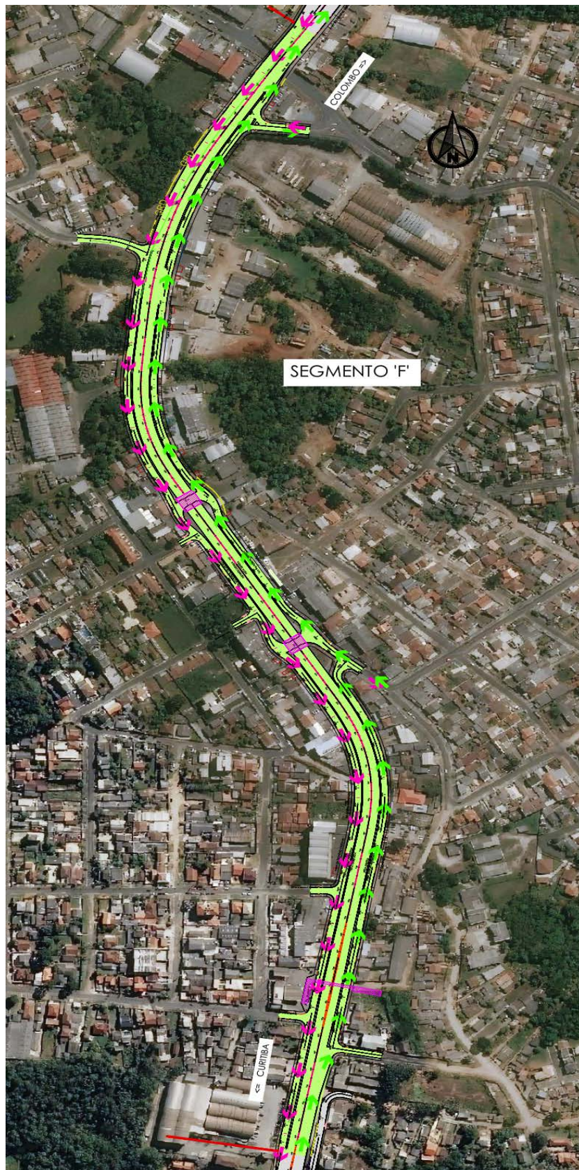
Figura 27 – Segmento F - desvio de tráfego
