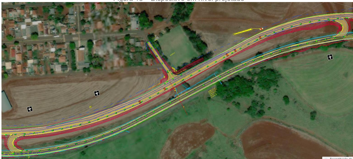
Figura 13 – Dispositivo em nível projetado
