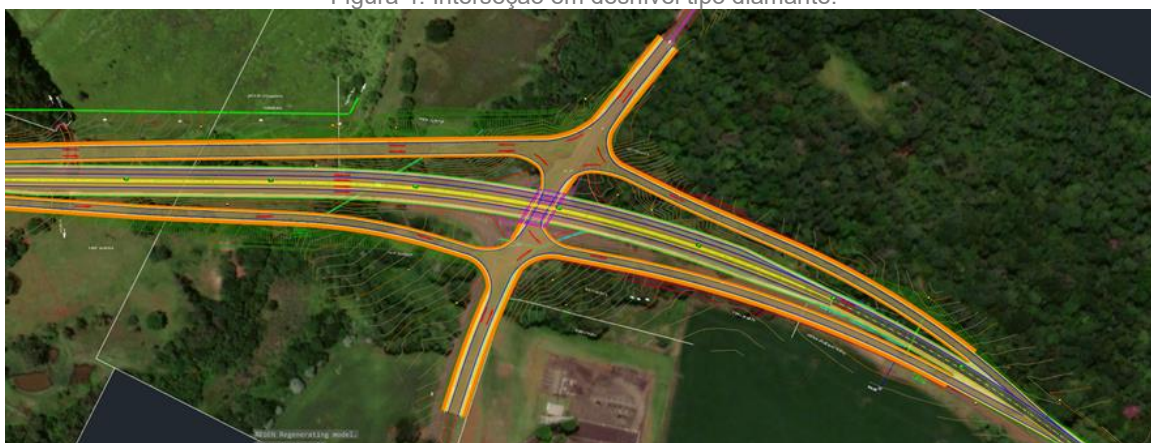
Figura 4: Interseção em desnível tipo diamante.
