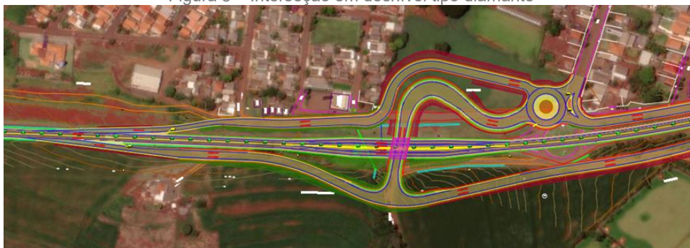
Figura 8 – Interseção em desnível tipo diamante
