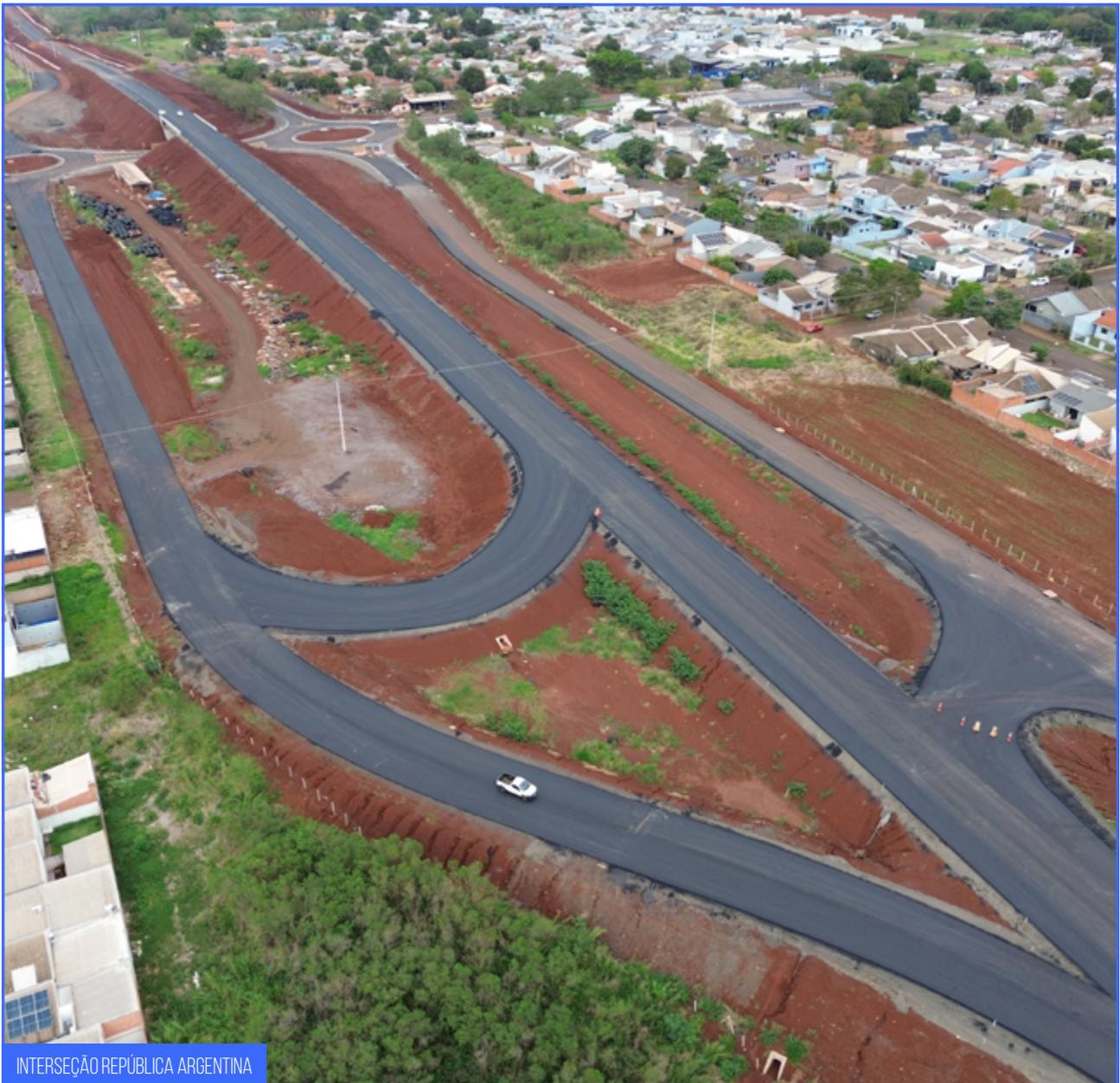
Na Pavimentação, mais de 7.500 toneladas de Concreto Asfáltico Usinado a Quente foram aplicadas, resultando em mais de 28.000 m<sup>2</sup> de área pavimentada neste período.
